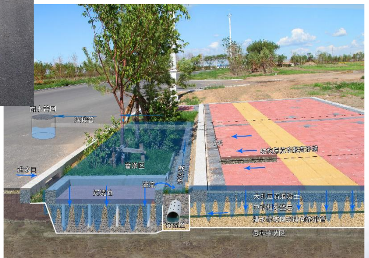
抗冻融透水铺装与融雪剂自动渗滤弃流原理图
